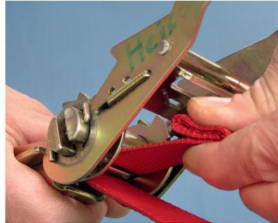
Abb. 129: Einfädeln des Gurtes in eine Ratschschließe
