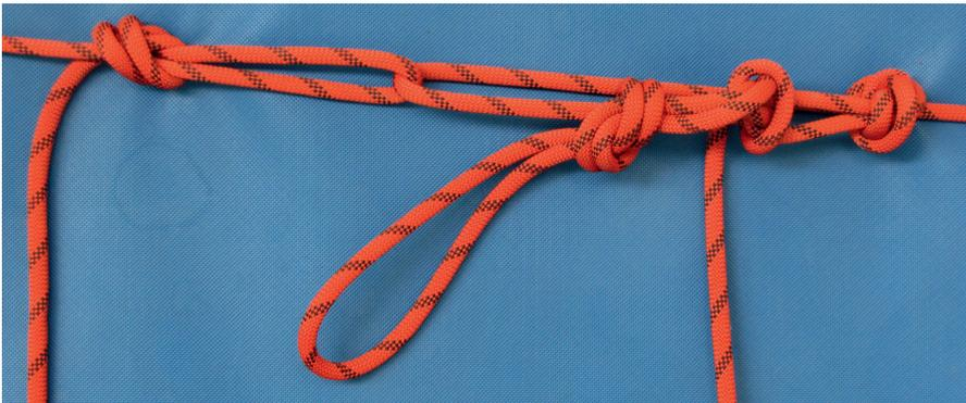
Abb. 125, oben: So sieht der Expressflaschenzug in der Spannleinentchnik vor dem Spannen aus. Beim Spannen geht die Zugrichtung nach links
